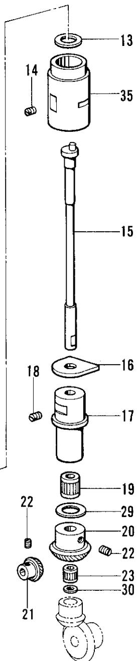
J4. カマ関係/Rotary hook mechanism/Greifervorrichtung/
