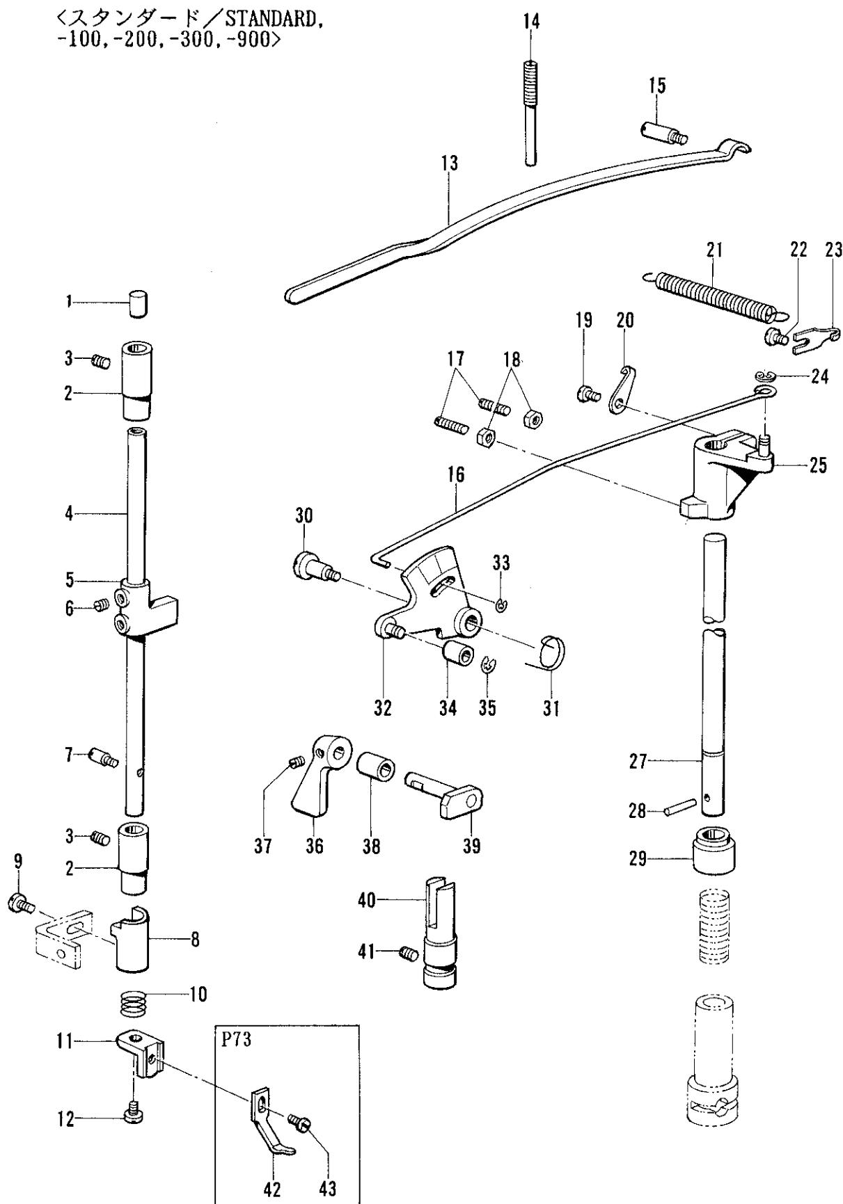
E. 押工関係/Presser foot mechanism/Stoffdrückerfuß/
