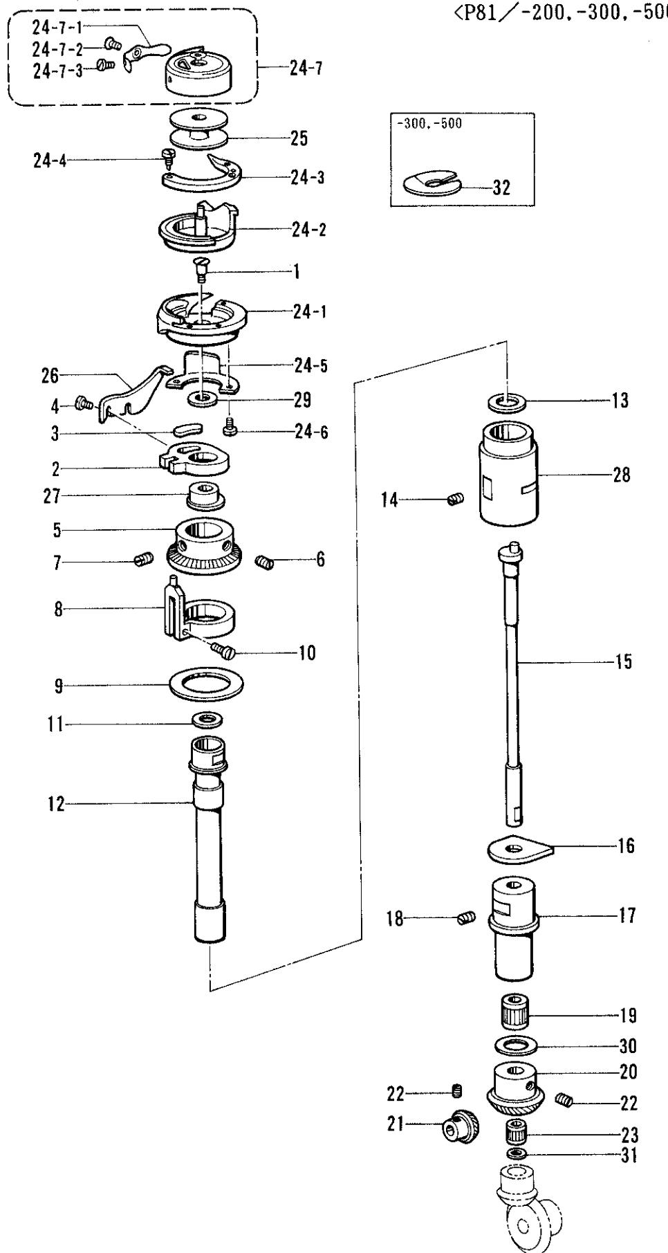
**J2. カマ関係/Rotary hook mechanism/Greifervorrichtung/
