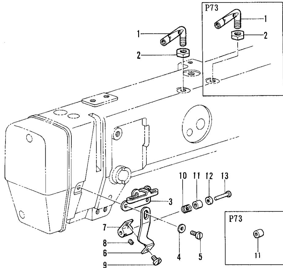
K2. 糸調子関係(糸切り) / Thread tension (Thread Trimmer) / Faderspannung (Fadenabschneider) /
