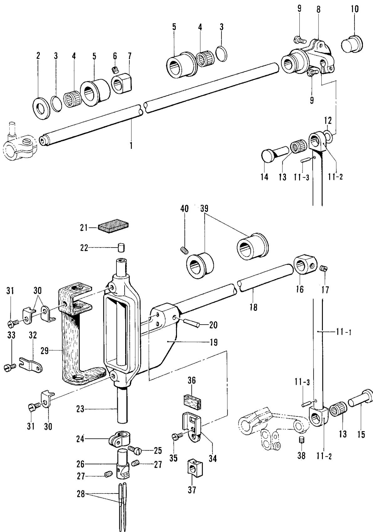
C2. 針棒振動関係 / Needle bar rocking mechanism / Nadelstangenbetätigung /
