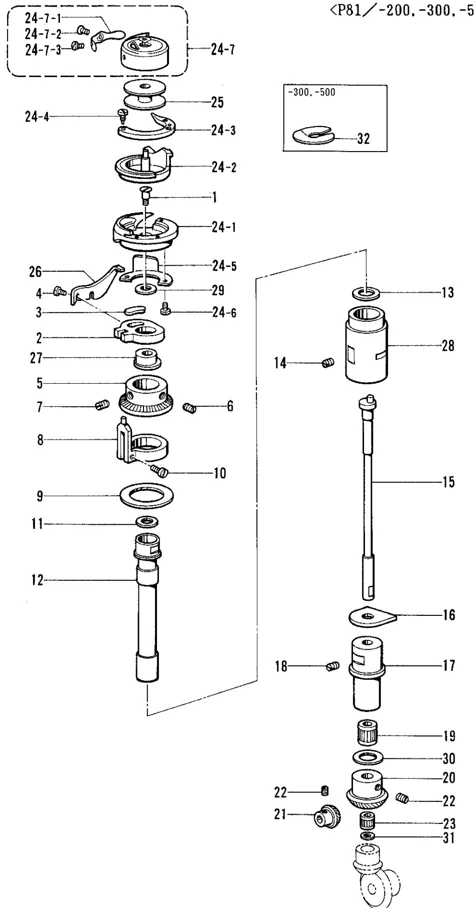
J2. カマ関係/Rotary hook mechanism/Greifervorrichtung/
