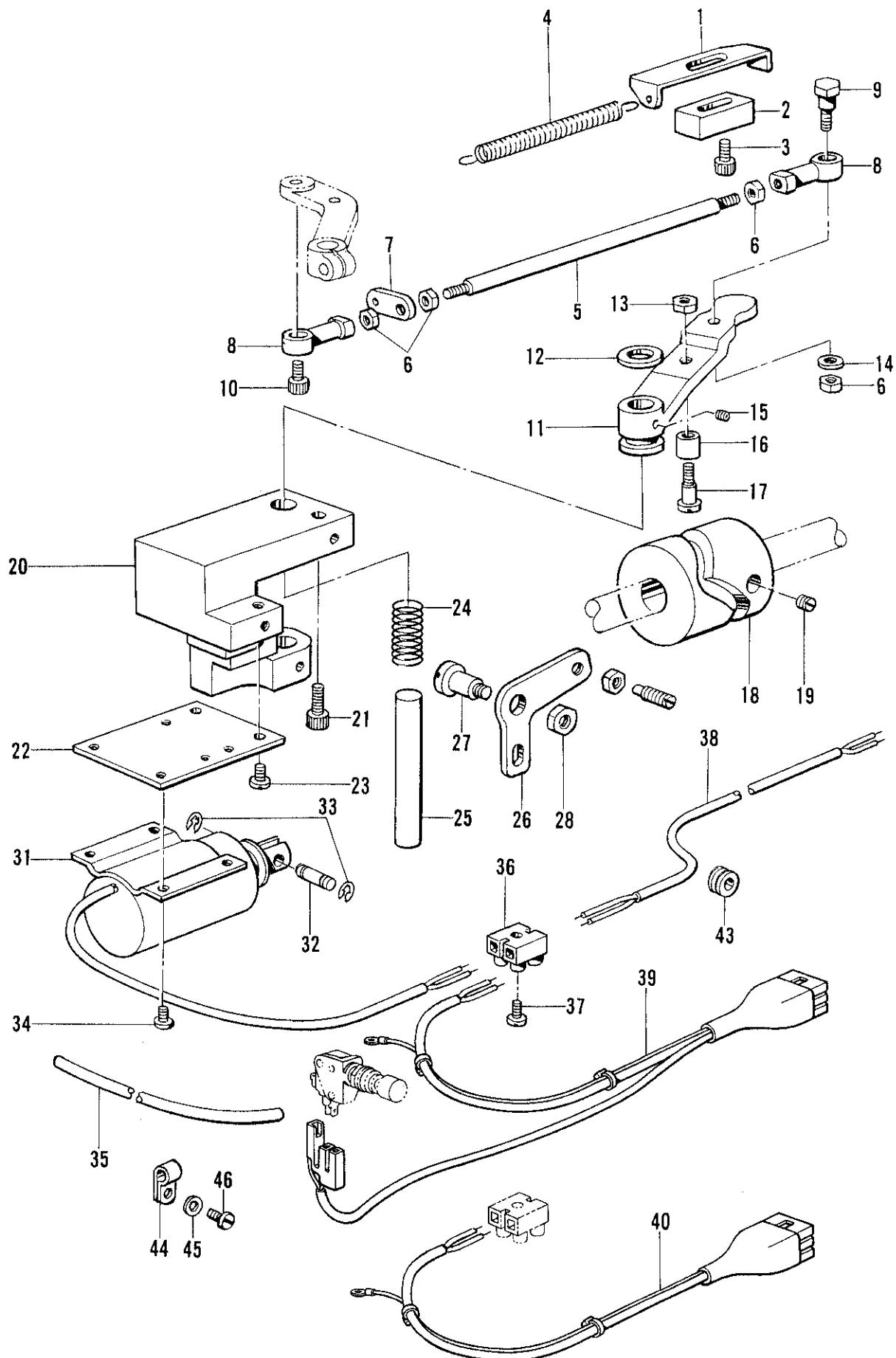
N1. 糸切り関係 / Thread trimmer mechanism / Fadenabschneidevorrichtung /
