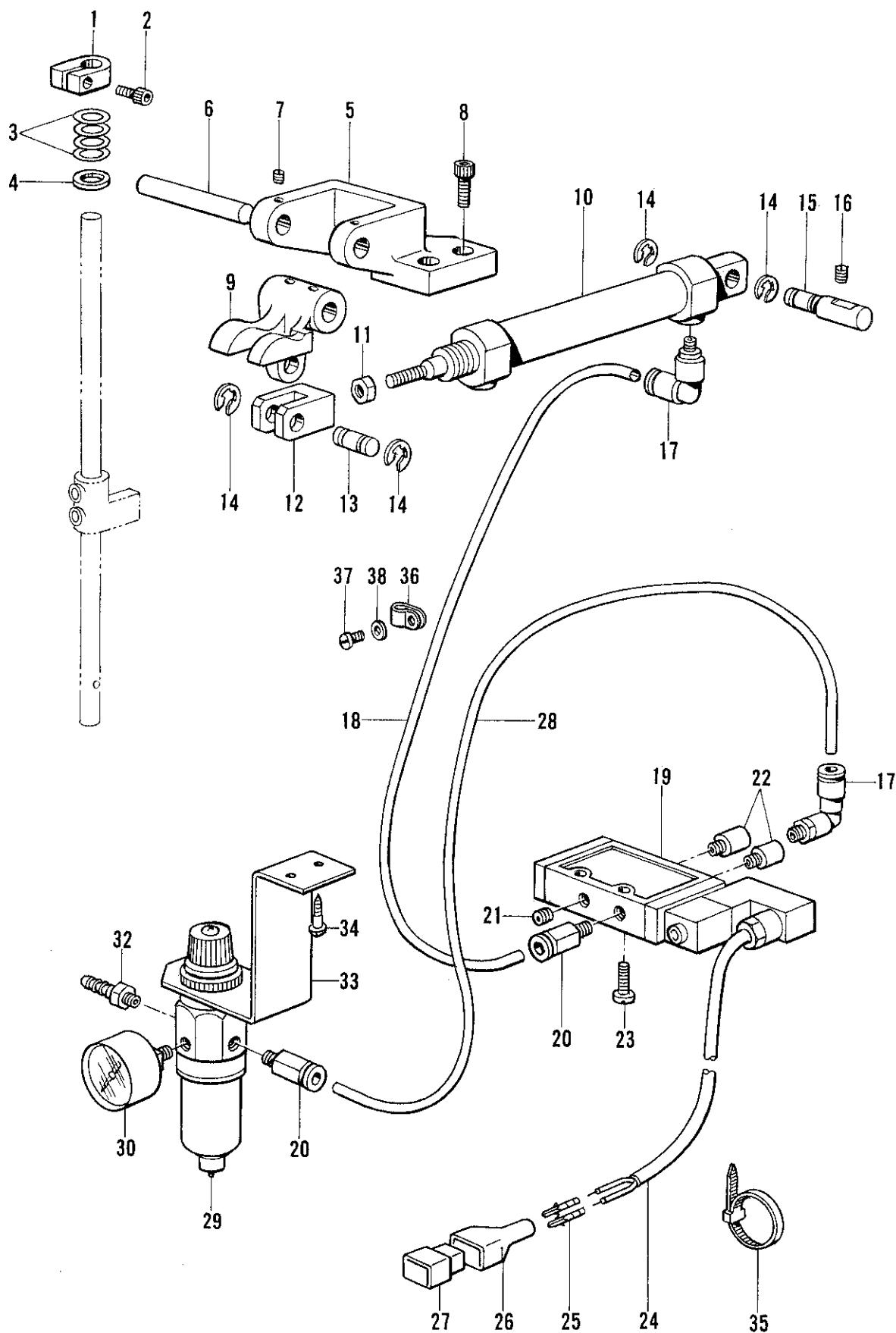
F. 押工上げ関係 / Work clamp lifter mechanism / Stoffhalterhebevorrichtung
