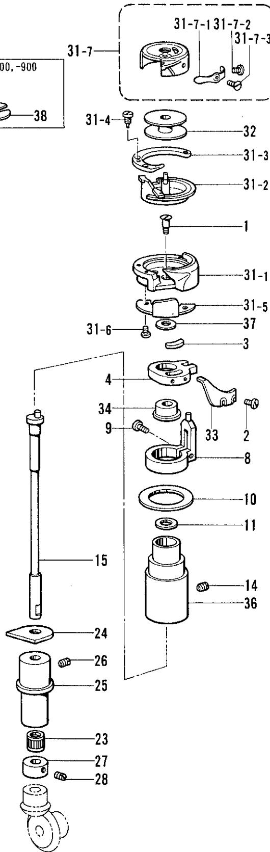
**J4. カマ関係/Rotary hook mechanism/Greifervorrichtung/
