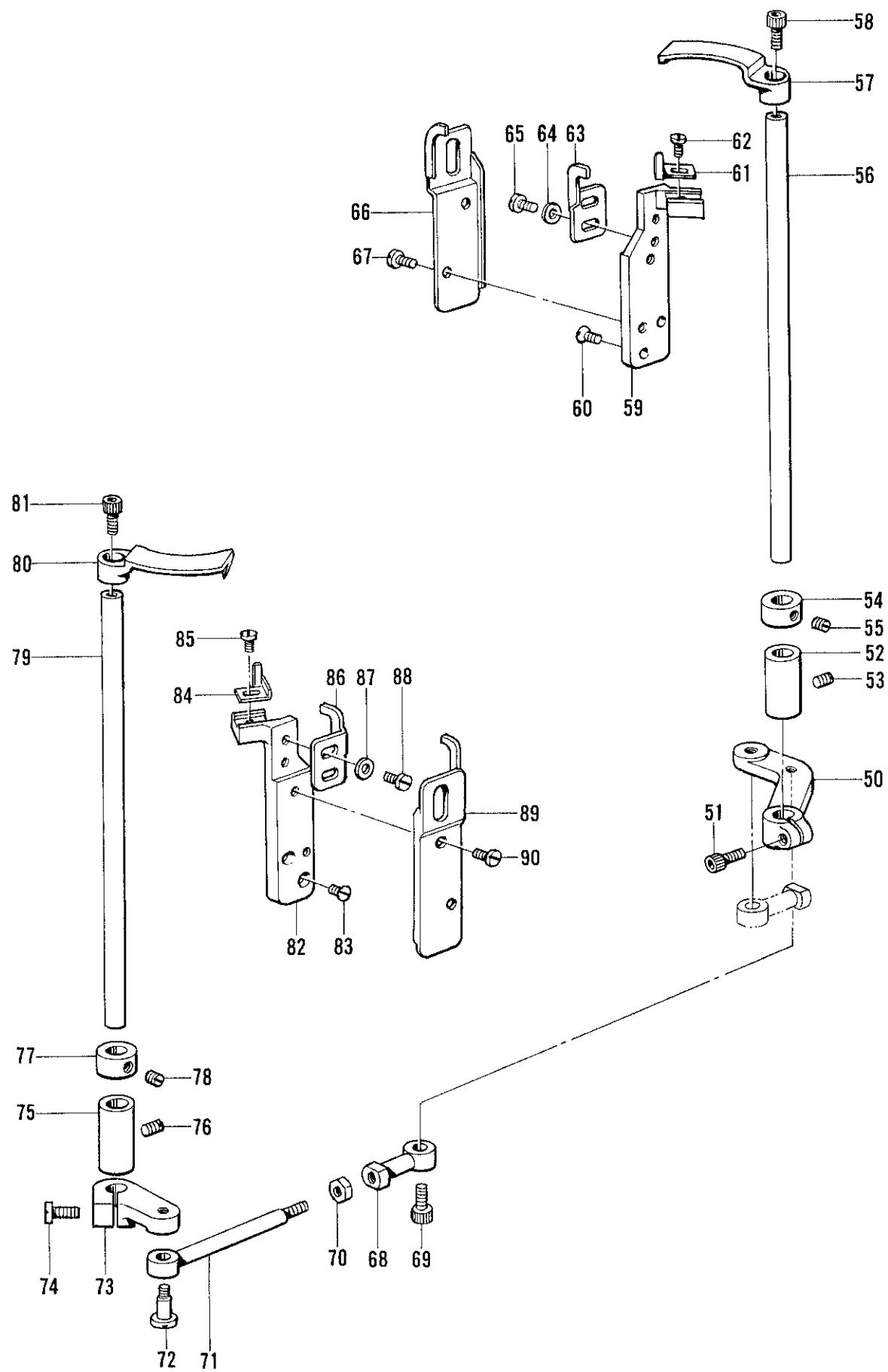
N2. 糸切り関係/Thread trimmer mechanism/Fadenabschneidevorrichtung/
