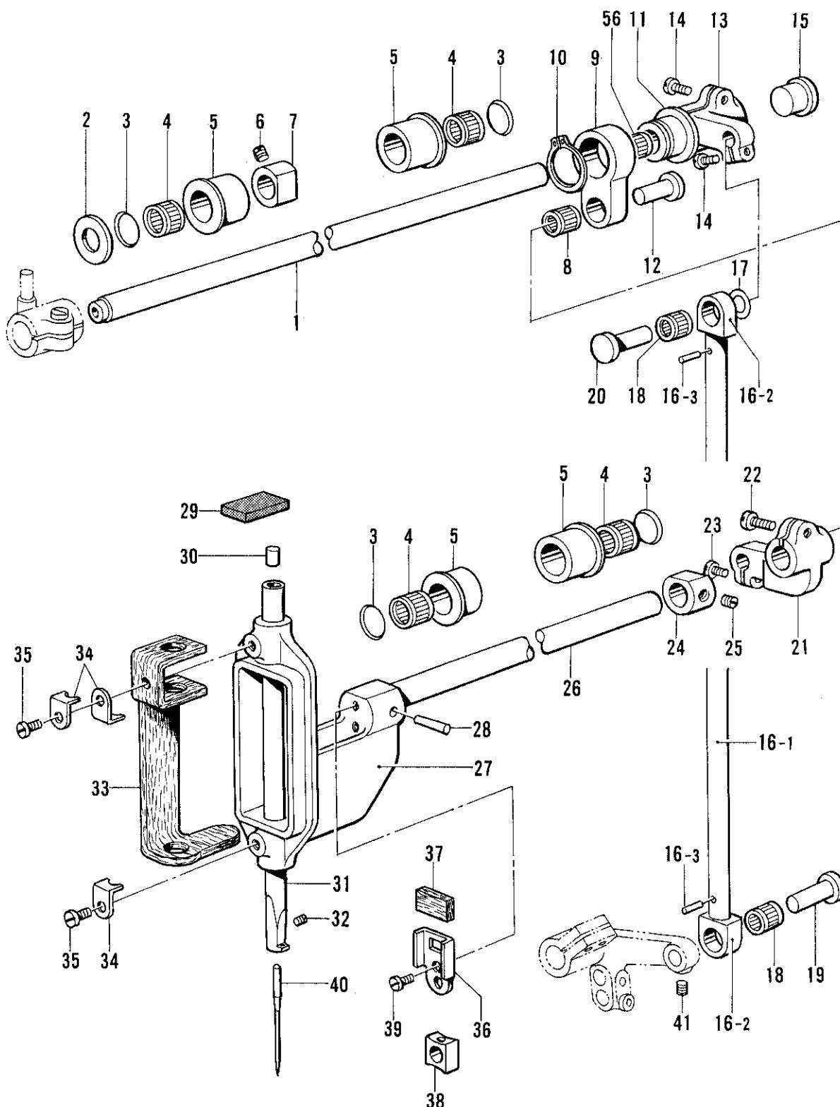
C1. 針棒振動関係 / Needle bar rocking mechanism / Nadelstangenbetätigung /
