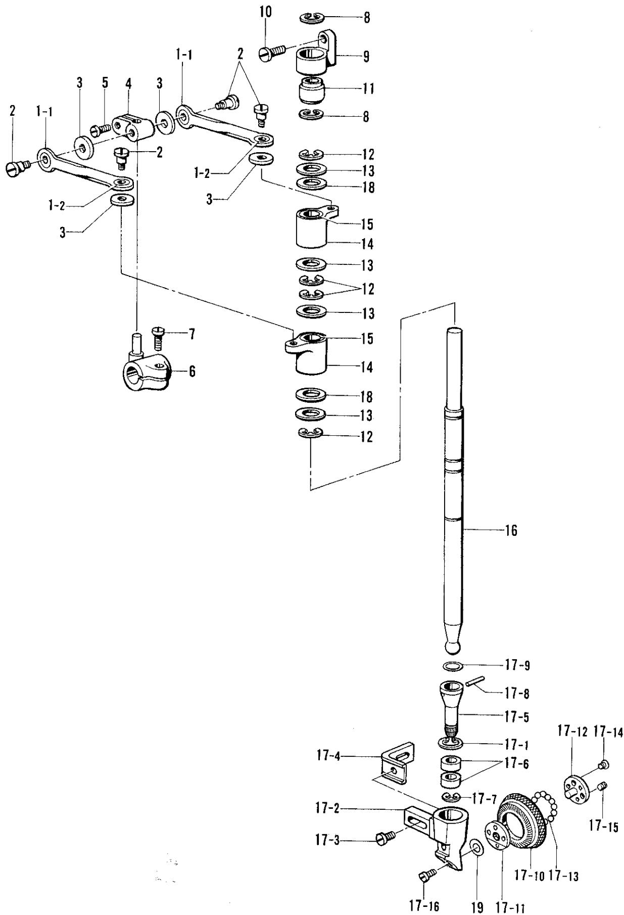
G. ローラー押工関係 /Roller presser foot mechanism/Rollenstoffdrückerfuß/
