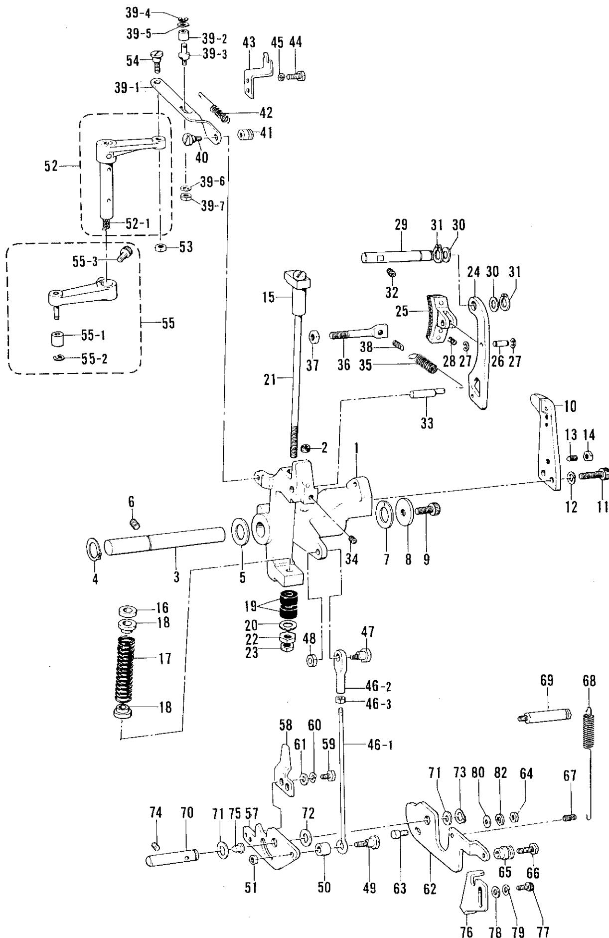
B. クラッチ関係/Clutch mechanism/Kupplungsvorrichtung/
