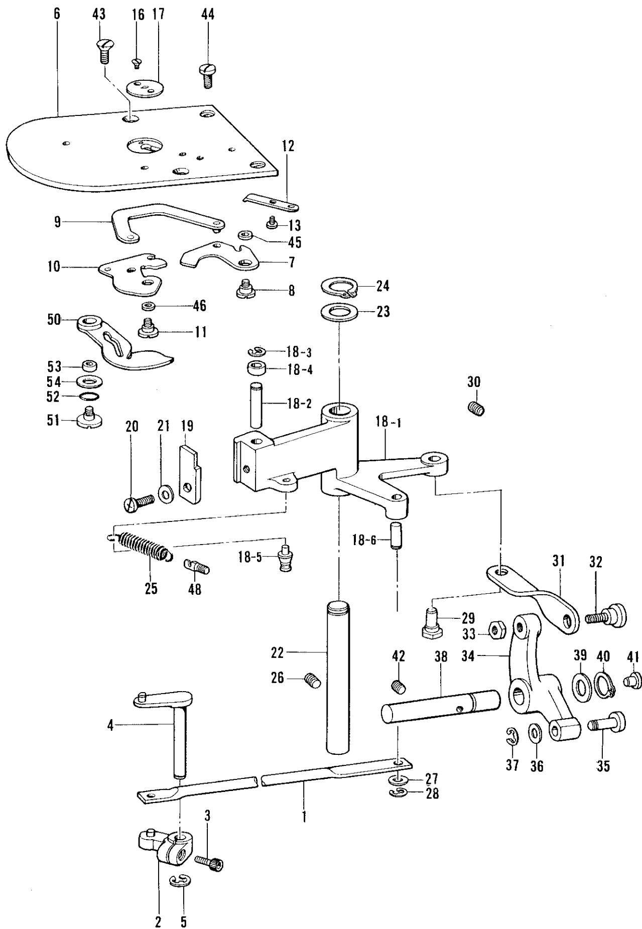
P. 糸切り関係/Thread trimmer mechanism/Fadenabschneidevorrichtung/
