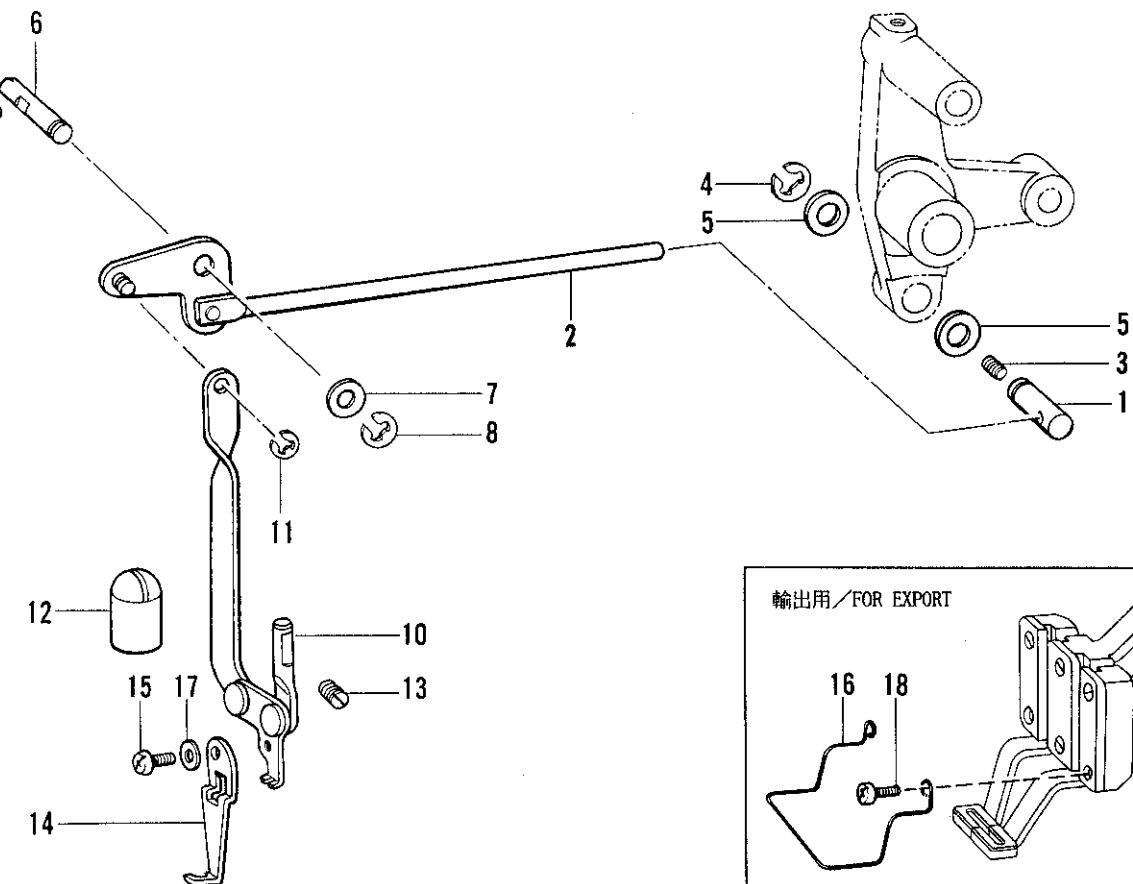
R. 糸締×関係 / Thread nipper mechanism / Fadenspannvorrichtung /
