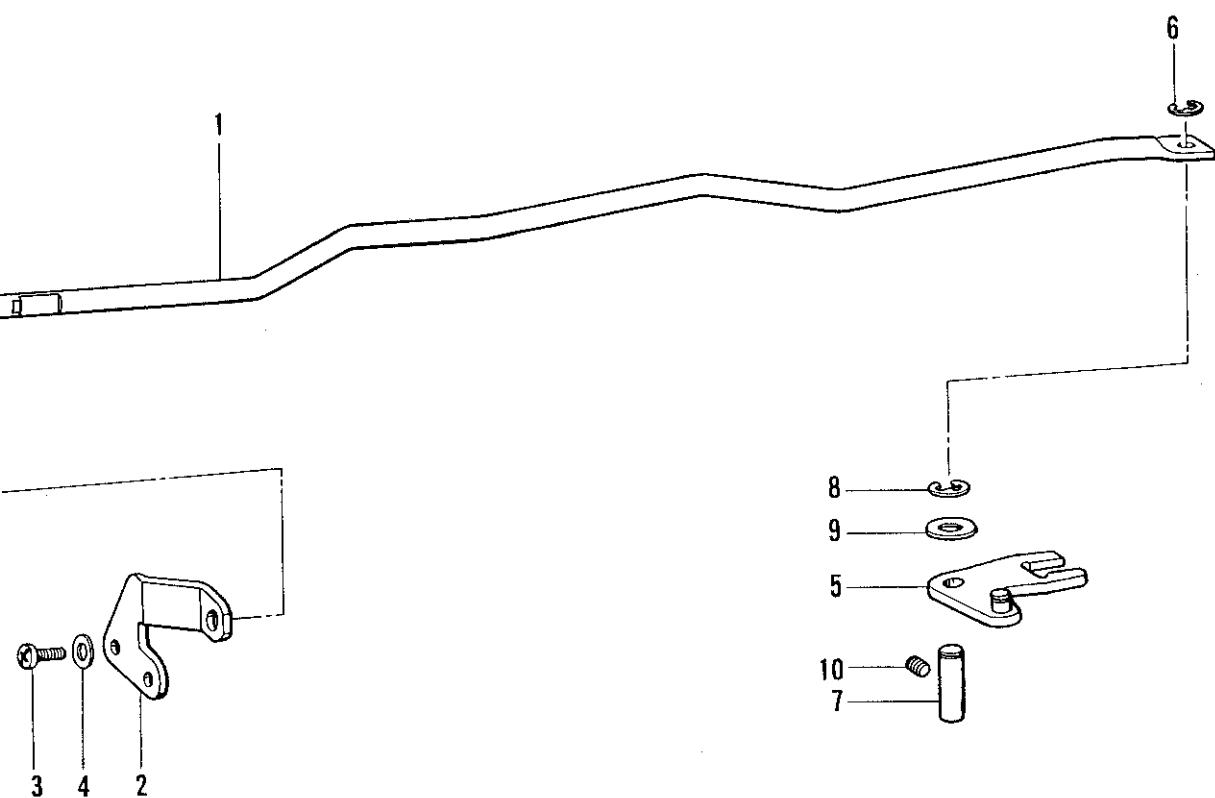
Q. 糸扱い関係 / Thread wiper mechanism / Fadenwischvorrichtung /
