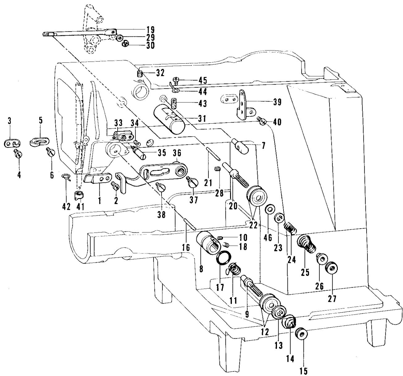
M. 糸通シ関係 / Threading mechanism / Fadenführungs vorrichtung /
