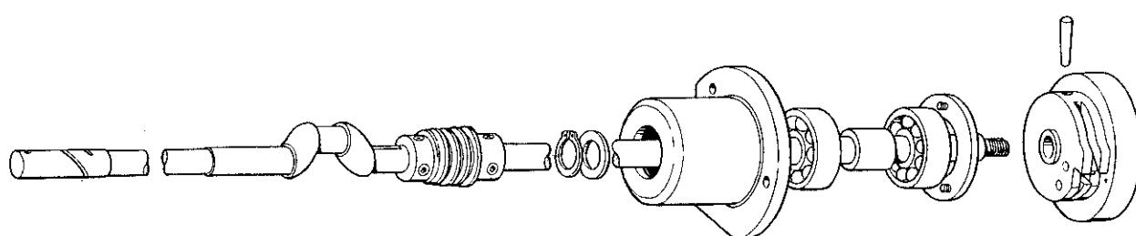
D. 動車・遊車関係 /Drive pulley and idler pulley mechanism/Antriebsriemenscheibe und Riemenscheibe/
