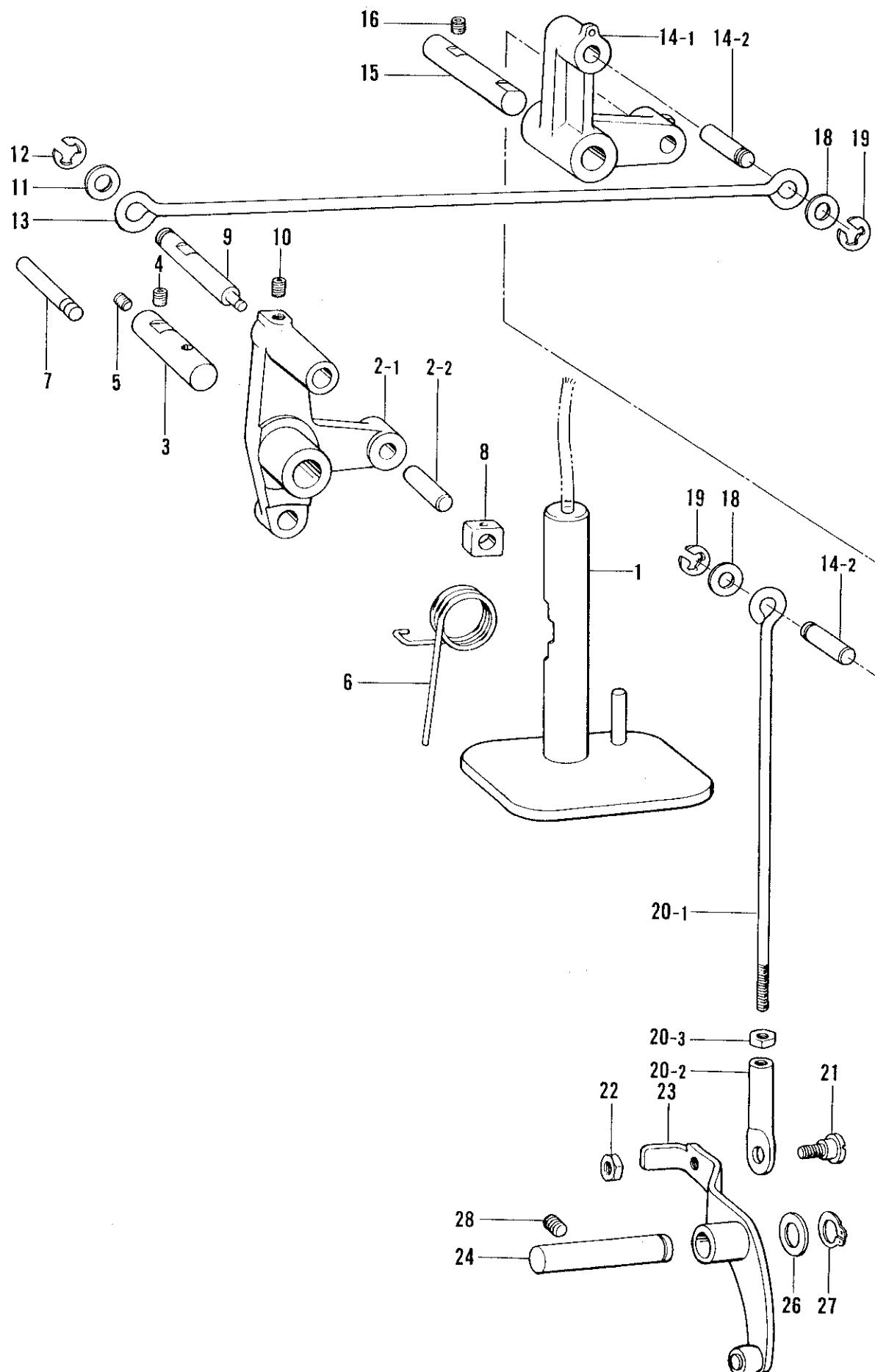
G. 押工上部関係/Work clamp lifter mechanism/Stoffhalterhebervorrichtung/
