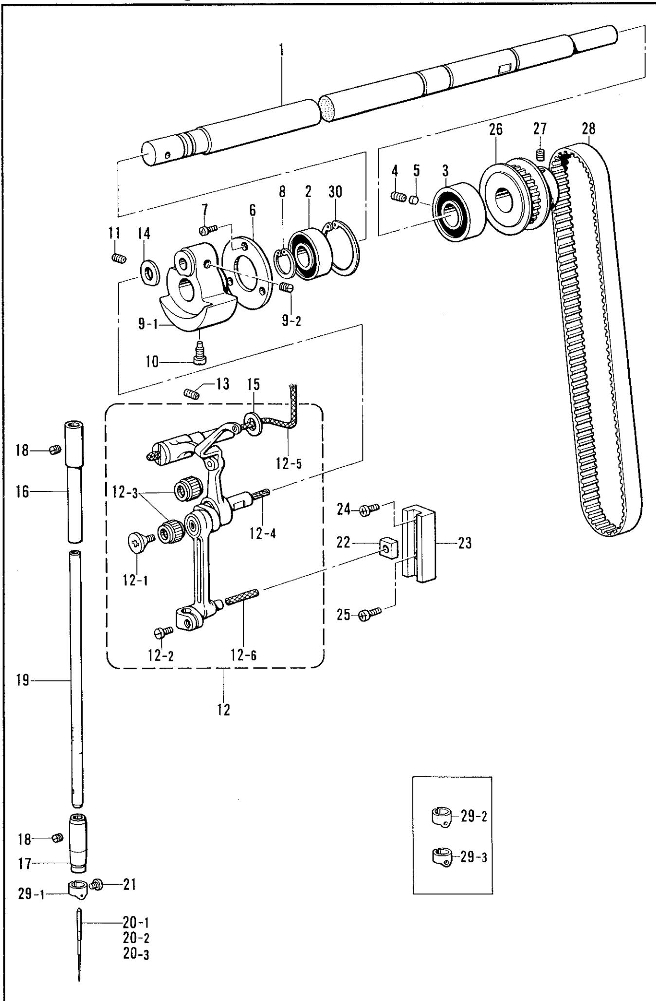
B. 針棒・天秤関係 / Needle bar and thread take-up mechanism / Nadelstangen und Fadenabnahmeverrichtung /
