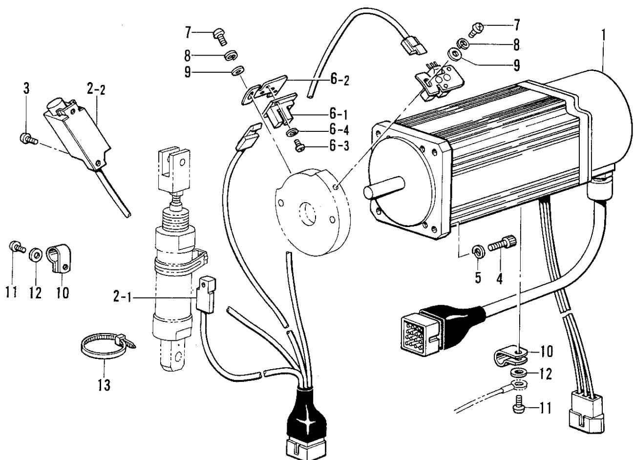
K. 糸ユルメ関係 / Tension release mechanism / Spannungsverminderungsvorrichtung /
