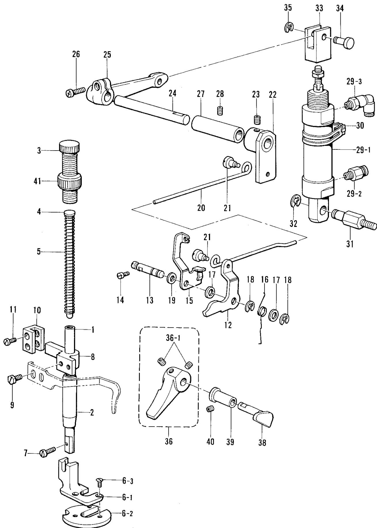
C. 押工関係/Presser foot mechanism/Stoffdrückerfuß/
