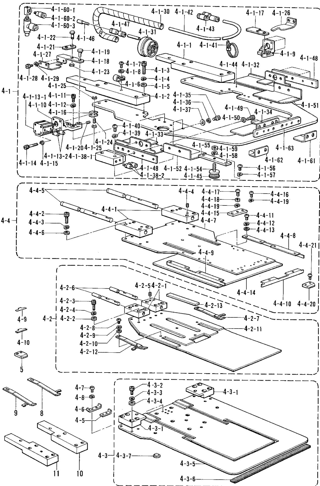
T. 折曲ヶ関係（特別注文部品）/Folding margin mechanism (Option parts)/Faltungsvorrichtung (Sonderzubehör)/
