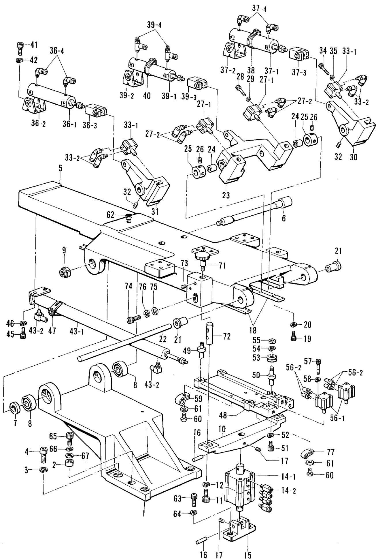
U. 折曲ゲ土台関係 / Folding margin base mechanism / Faltungsvorrichtungsgrundplatte /
